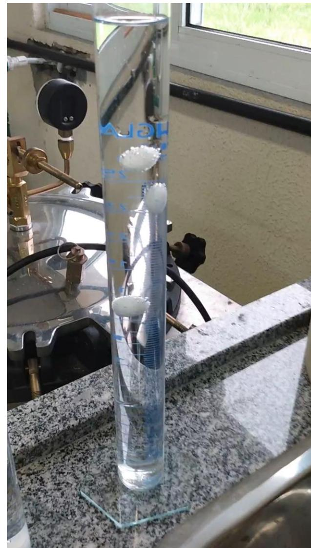
Reação do ácido acético do vinagre com bicarbonato de sódio com produção de gás carbônico.
