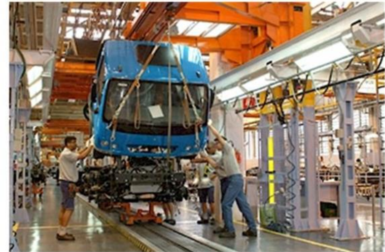
Linha de produção do caminhão Accelo localizada na unidade da DaimlerChrysler em São Bernardo do Campo
