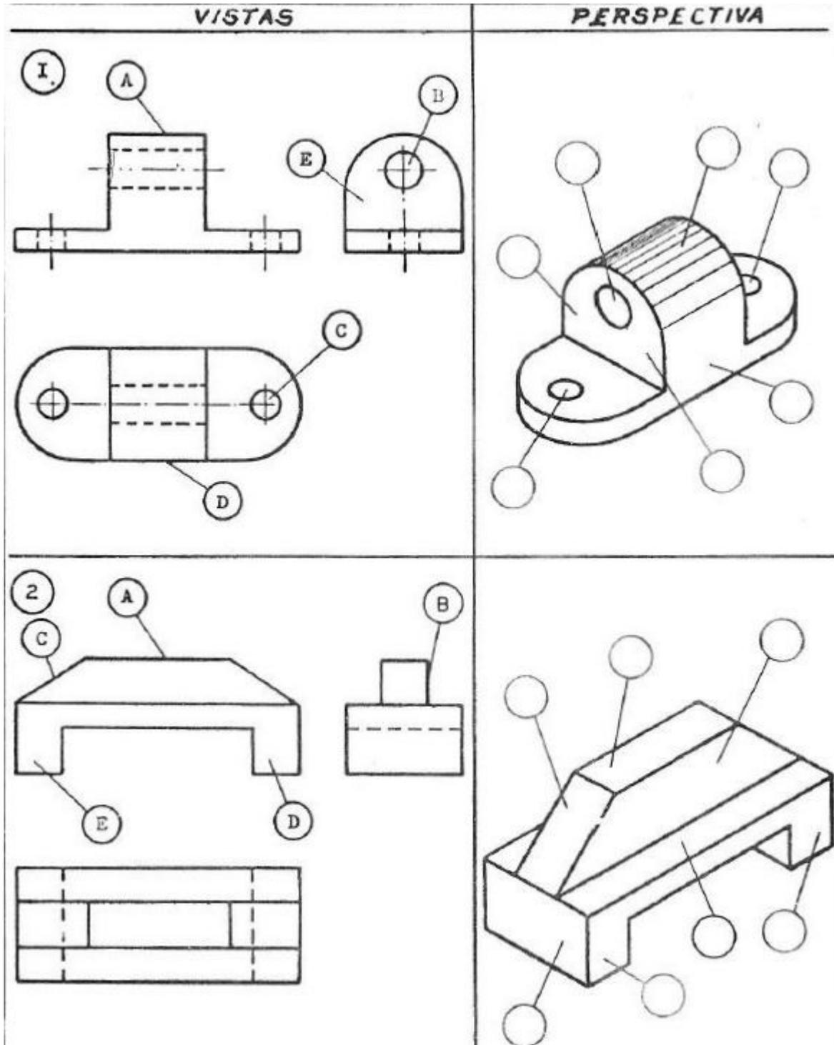
Observe que nas vistas desenhadas à esquerda existem elementos indicados com letras A, B, C, D e E. Procure identificá-los com as mesmas letras na perspectiva à direita.
