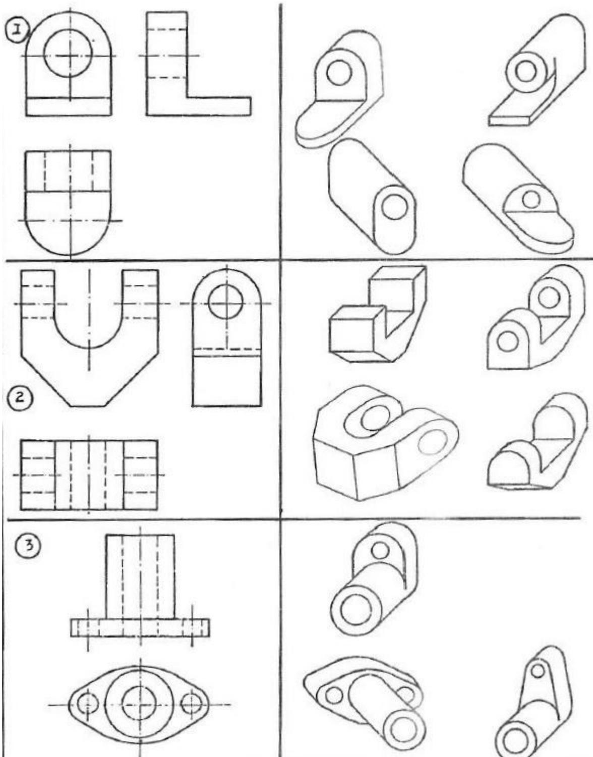
Assinale com um (X) qual das quatro peças colocadas à direita corresponde as vistas da coluna à esquerda.
