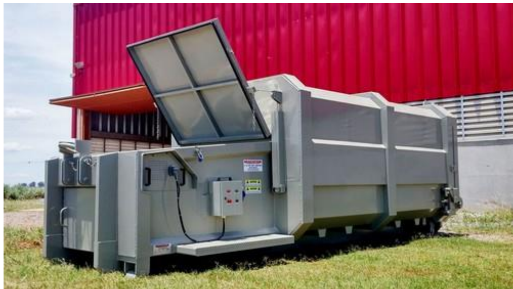
Estação de transferência com compactação.
