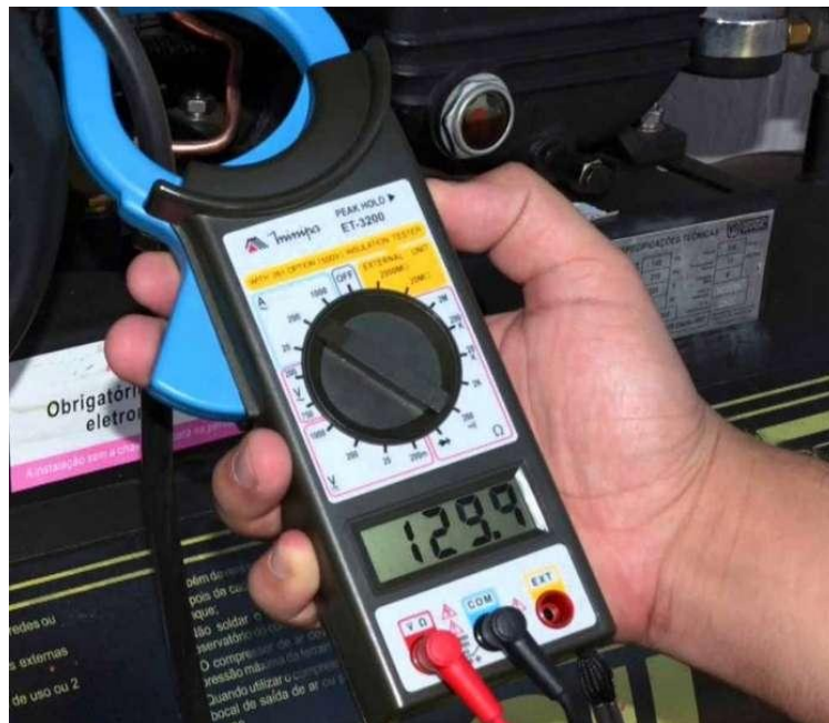
Medindo corrente elétrica com um alicate amperímetro.
