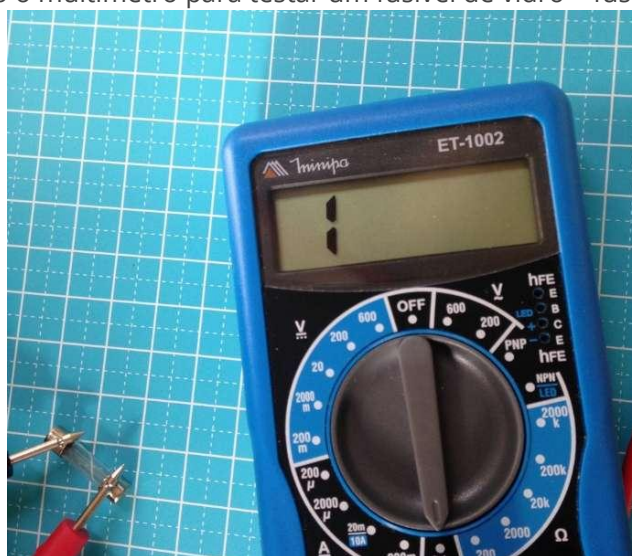
Usando o multímetro para testar um fusível de vidro – fusível queimado
