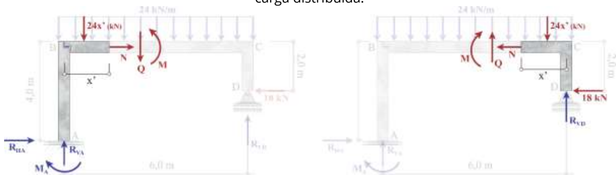
Figura 11 - Solução de Pórtico Rotulado: ilustração de duas possibilidades de cortes em meio a carga distribuída.
