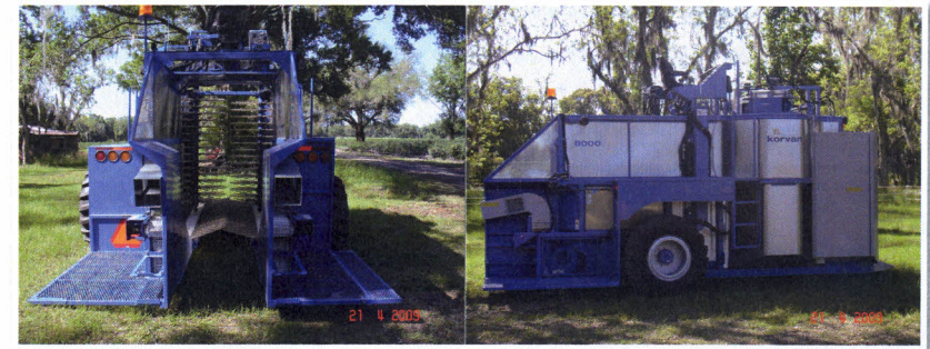
Figura 25. Máquina para colheita mecânica de mirtilos (Foto: Luis E. C. Antunes, 2009).
